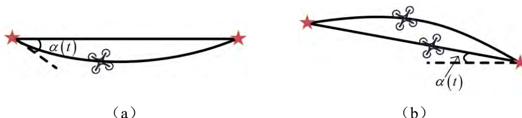
图 11 无人机爬升（俯冲）飞行示意图（x-z 轴或 y-z 轴方向投影）
